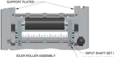
INPUT SHAFT SET SCREWS IDLER BLOCK SCREWS
